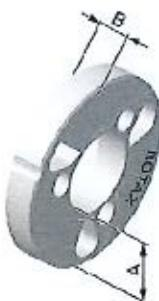
La misurazione deve essere presa verso i 3 punti aperti della frizione, 5 a 10 mm della scanalatura lavorata Tutti i pezzi della frizione devono essere completamente chiusi, senza divario.
